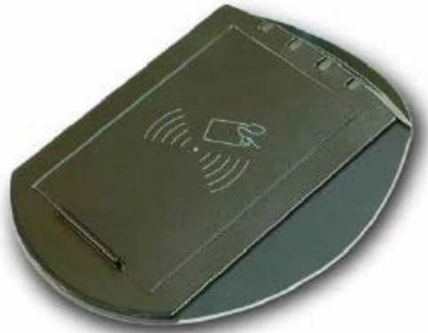
读卡器支持 ISO14443A、ISO14443B 和 ISO15693 标准的 IC 卡协议。
